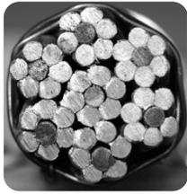
Las partes que forman un cable de acero son los alambres, los torones y el alma. El diseño o arreglo de estas partes es a lo que se le llama "construcción".
